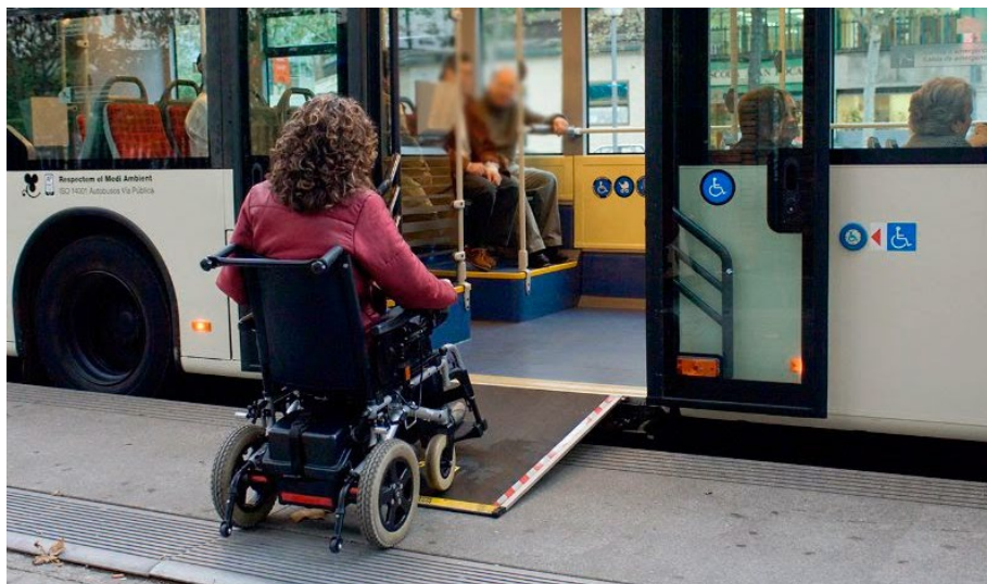
Рисунок 4.16.6 – Пример применения механической аппарели автобуса на посадочной площадке в габаритах места посадки инвалидов
